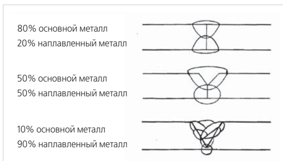
Доля участка наплавленного металла зависит от подготовки соединения под сварку
