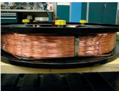
Рисунок 2. 100 кг катушка для проволоки компании ESAB
