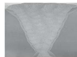
Порошковая проволока ОК Tubrod 15.24S – 37 проходов
