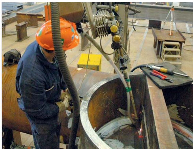
Сравнение производительности наплавки порошковой проволокой ОК Tubrod 15.00S и сплошной ОК Autrod 12.20 с флюсом ОК Flux 0.71
