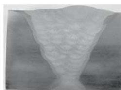
Сплошная проволока – 48 проходов
