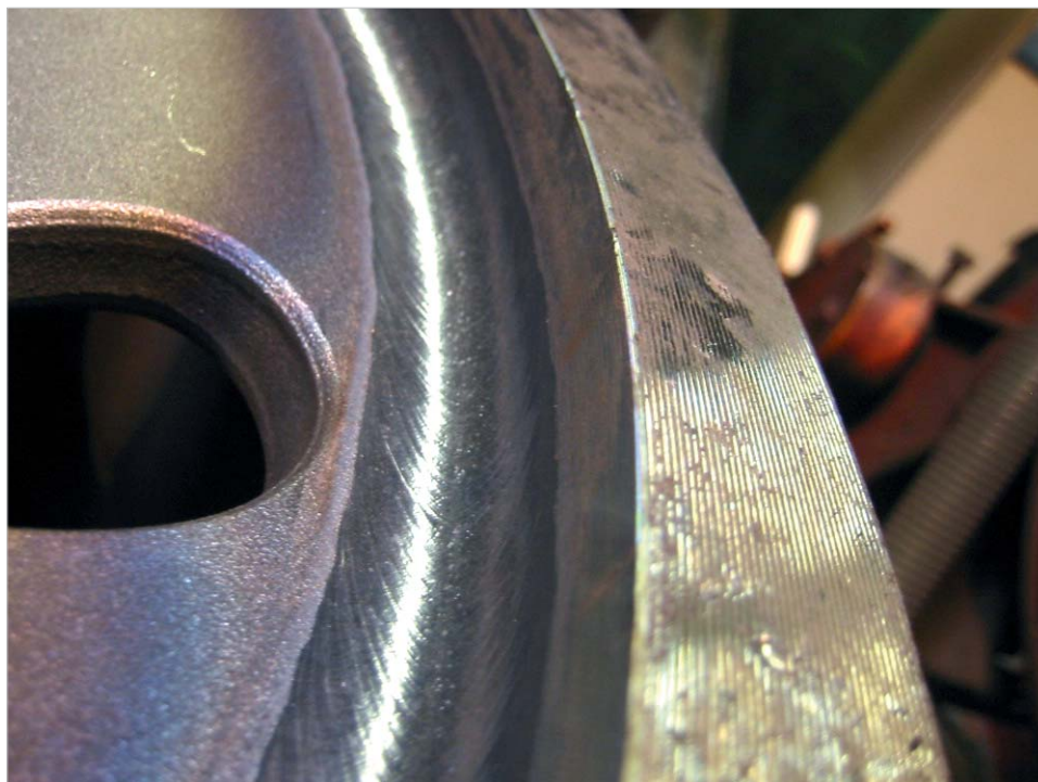
Угловой шов, выполненный в нижнем положении H1(PA) (в лодочку), с отличным смачиванием свариваемых кромок и гладкой поверхностью.
