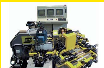
Установки и линии сварки балок
